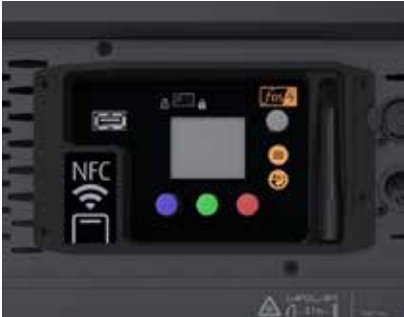
无线 DMX/RDM 及 NFC 通过您的手机或平板配置并控制您的灯具，或在您的控制台搭配 Multiverse 使用 DMX/RDM
